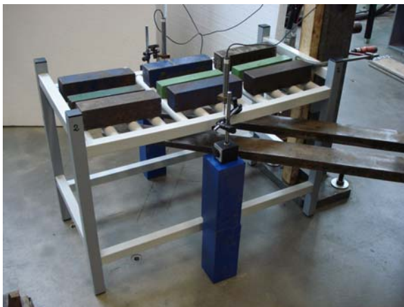
Fig.2. Legbord belast met 75 kg
