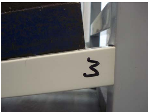
Fig.4. Legbord belast met 225 kg
