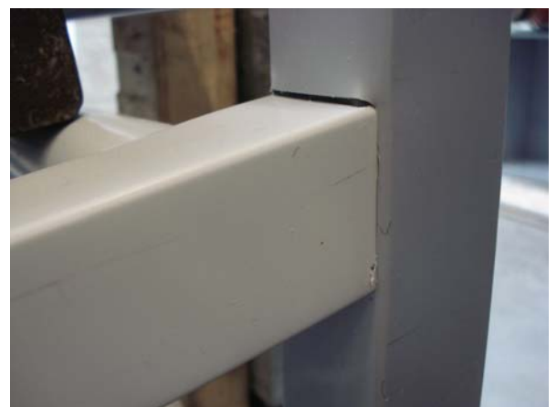
Fig.5. Legbord belast met 225 kg
